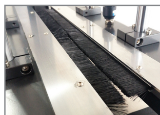
DETTAGLIO PRESSINO PNEUMATICO PNEUMATIC TOP PRESS
