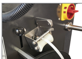
CARICAMENTO AUTOMATICO DELLA REGGIA AUTOMATIC STRAP LOADING
