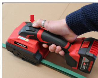
Tensionamento tramite pulsante Tensioning by button
